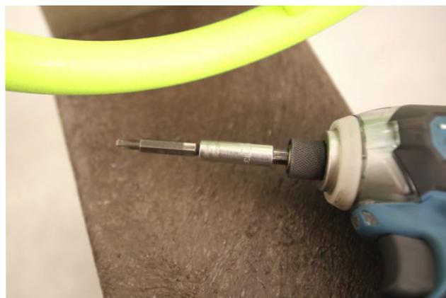
Fixez les 10 volants avec les vis en acier inoxydable T25 à travers la plaque en plastique. Les trous dans les planches beiges sont marqués.
