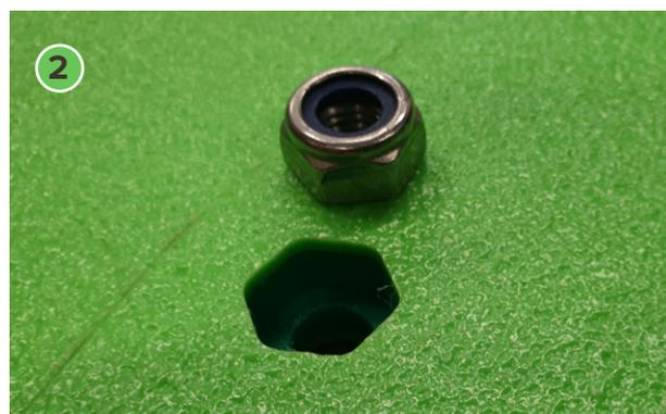
2. Fixez d'abord les contre-écrous dans les trous prévus à l'arrière des panneaux. L'anneau bleu dans le contre-écrou doit être orienté vers l'intérieur de la planche. La soie hexagonale ne doit donc pas être visible du dos du panneau.
